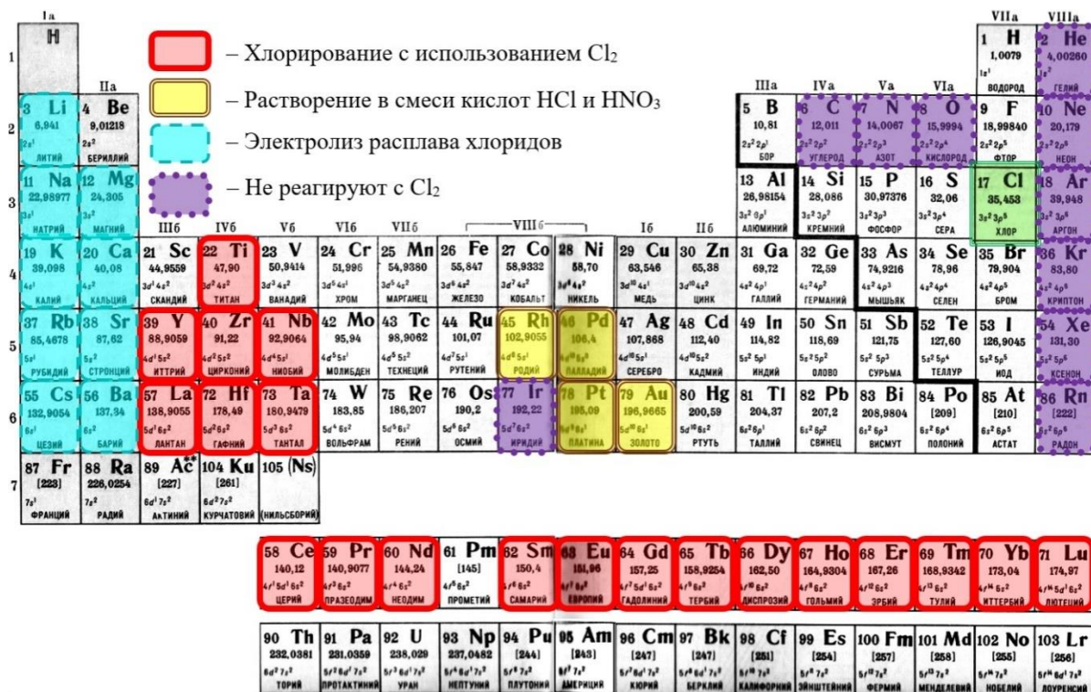
Рис. 1. Место хлора в периодической таблице химических элементов имени Д.И. Менделеева и наиболее важные технологические процессы в металлургии, связанные с использованием хлора.
